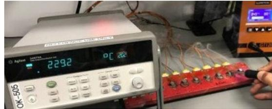
Las termocuplas tipo K se soldaron por puntos a la punta del soldador de cada sistema de soldadura que se estaba probando. Para minimizar el error de medición de la temperatura de la punta y garantizar un contacto térmico uniforme, el dispositivo de prueba fue diseñado para que cada soldador hiciera contacto con la carga térmica en un ángulo de 15 grados respecto del plano horizontal como se muestra arriba.
