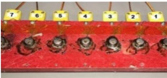
Las cargas de prueba se colocaron en un dispositivo de prueba como se muestra. El material base es resina fenólica para evitar la
