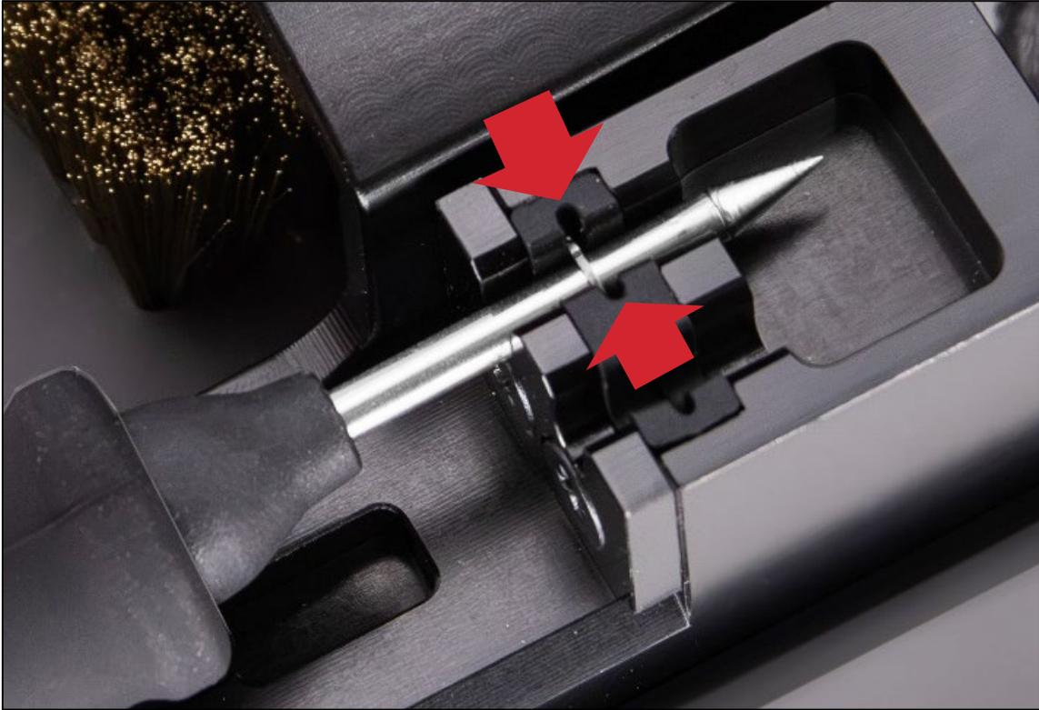
Handstück vorsichtig nach hinten ziehen und die Patrone sicher in der Entfernungsvorrichtung ablegen. Möglicherweise müssen Sie den Ablagegeständer beim Ziehen mit der anderen Hand stabilisieren.
