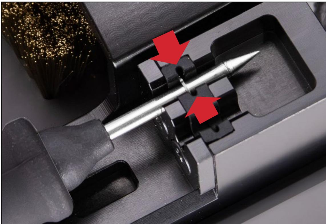
Tire con cuidado de la pieza manual hacia atrás, dejando el cartucho de forma segura en la herramienta de extracción. Es posible que necesite sujetar el soporte de trabajo con la otra mano mientras tira.
