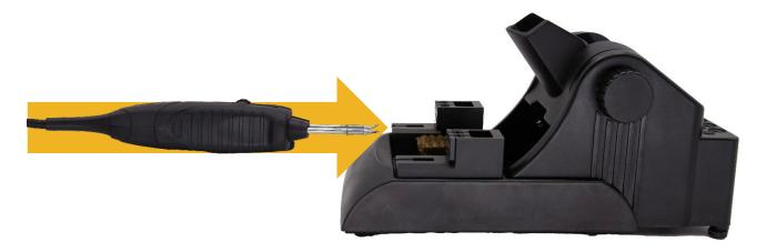
Gire la pinza hasta que el anillo de alineación de la punta que desea ajustar esté en posición horizontal.
