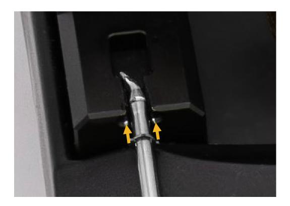
Con la punta firmemente en la herramienta de alineación, gire la pinza lentamente en la dirección requerida hasta que la punta esté en la posición deseada.
