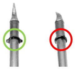
Cuando esté en posición horizontal, las alas del anillo de alineación coincidirán con la abertura de la herramienta de alineación en la parte delantera del soporte de trabajo.
