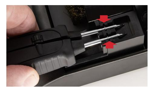
Tire con cuidado de la pinza hacia atrás, dejando los cartuchos de forma segura en la herramienta de extracción. Es posible que necesite sujetar el soporte de trabajo con la otra mano.
