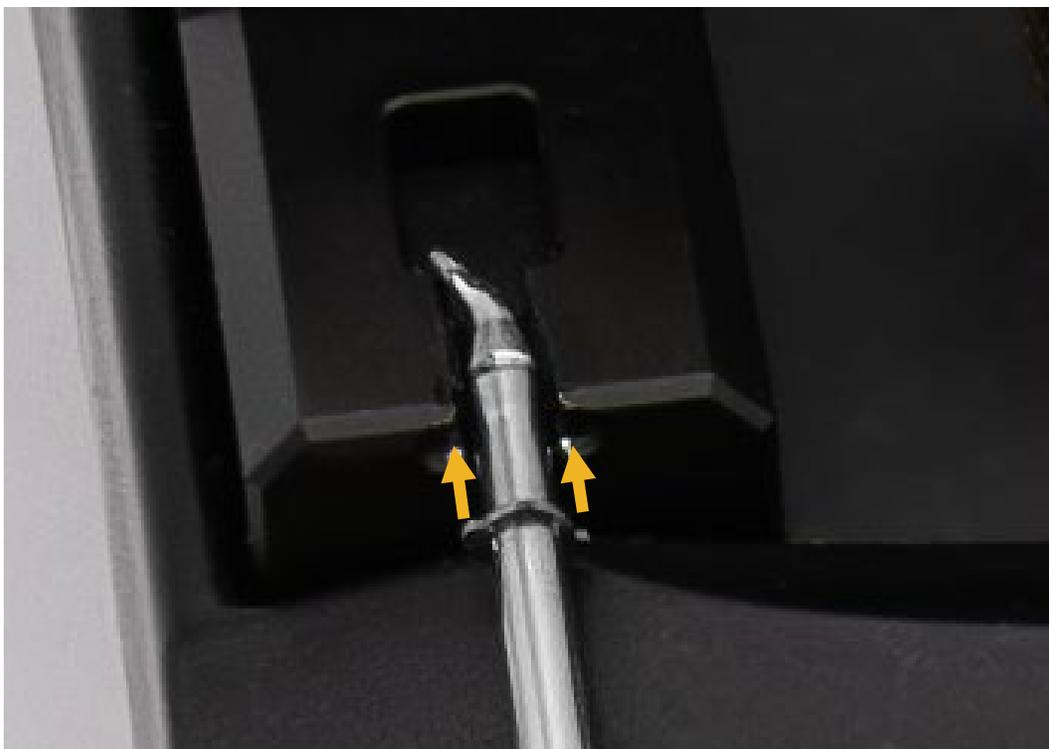
Con la punta saldamente inserita nello strumento di allineamento, ruotare lentamente la pinzetta nella direzione richiesta fino a raggiungere la posizione desiderata.
